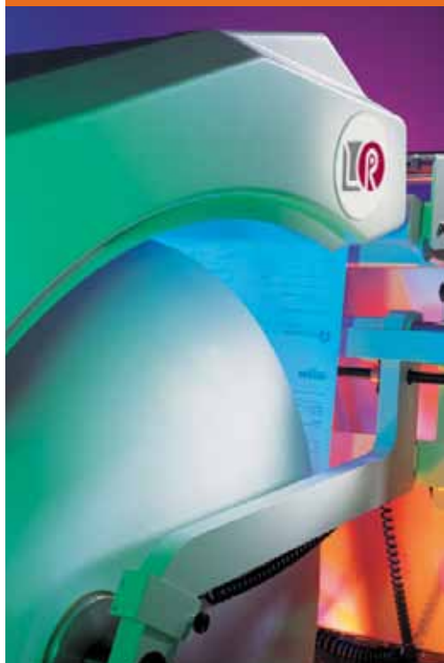
Der DocuSheeter iG arbeitet in Verbindung mit dem Xerox iGen3/4 -Drucker und ist mit Abroller, Schneider und Blatttransport ausgestattet.
